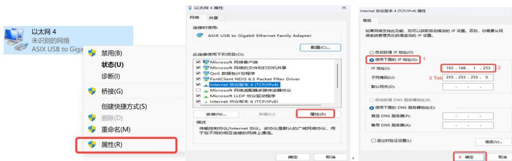
Figure 4-2.CS40Pro 配置 IP 步骤 1,2,3 示意图
